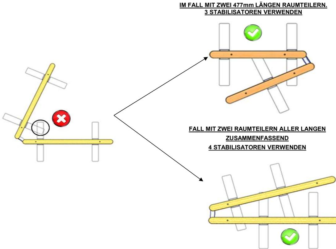
**3C): POSITIONIERUNG DER STABILISATOREN (3 UND MEHR ZUSAMMENKLAPPBARE TRENNWÄNDE)**
