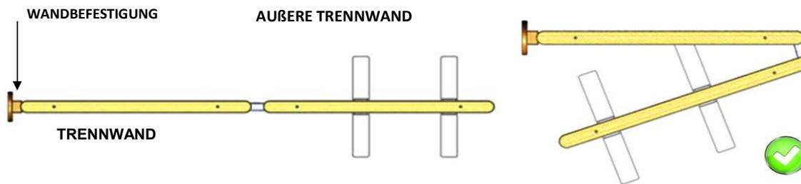
**3F) : POSITIONIERUNG DER STABILISATOREN (3 UND MEHR ZUSAMMENKLAPPBARE TRENNWÄNDE + WANDBEFESTIGUNG)**
