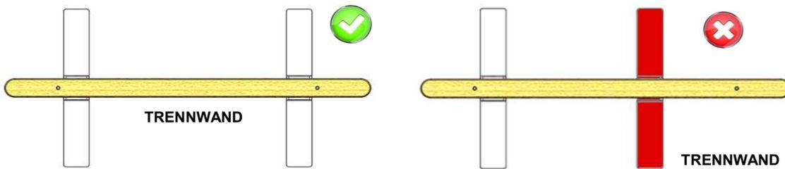
Es sollten immer 2 Stabilisatoren (im Lieferumfang enthalten) pro Trennwand verwendet werden, unabhängig davon, ob sie allein stehen oder mit anderen zu einem Laufstall oder einer festen Trennwand verbunden sind.
