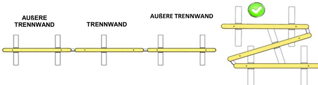
Bei einer Aufstellung mit drei oder mehr Trennwänden werden zwei Stabilisatoren an den äußeren Trennwänden angebracht. (Die Position zwischen den beiden Stabilisatoren sollte so weit wie möglich entfernt sein).
