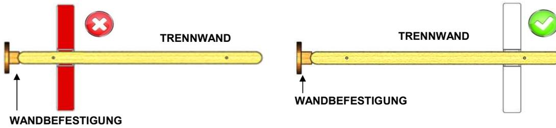
Bei einer Aufstellung mit einer Wandhalterung bringen Sie einen Stabilisator an, der am weitesten von der Wandhalterung entfernt ist.
