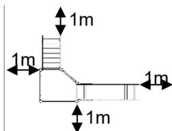
La structure de motricité SG30 doit être positionnée de telle sorte qu'aucun obstacle ne vienne gêner l'intervention de l'adulte. Vous devez pouvoir aisément accéder à l'escalier, au podium et au plan de glisse de la structure.
